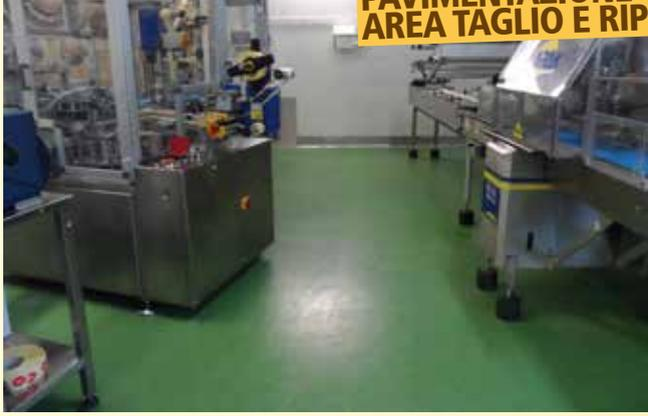
La quasi totalità dello stabilimento ha visto il **completo rifacimento del pavimento** attraverso la stesura di resina su una superficie di circa 600 mq. Un intervento complesso che ha reso necessario lo spostamento degli impianti esistenti, ma che ha avuto il merito di cambiare in meglio l'immagine dell'area produttiva.
