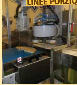
Con l'obiettivo di rendere funzionale ed efficiente la disposizione delle linee di porzionatura **sono stati effettuati degli spostamenti**: la macchina da taglio della linea Tecnosystem è stata spostata dalla zona taglio e avvicinata alla confezionatrice, permettendo l'**installazione di un robot** e dando una nuova sistemazione della confezionatrice degli stick.
